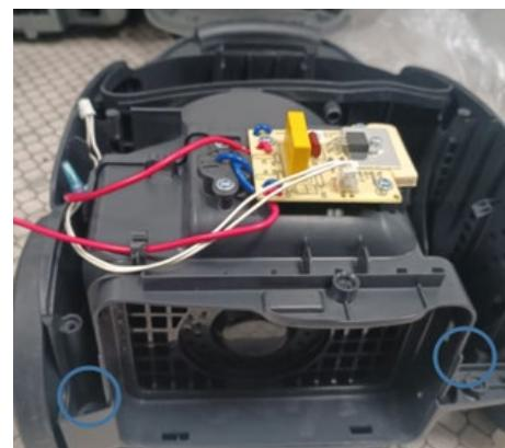
09. Retirez le connecteur du potentiomètre situé sur la couverture arrière et le connecteur du commutateur.
