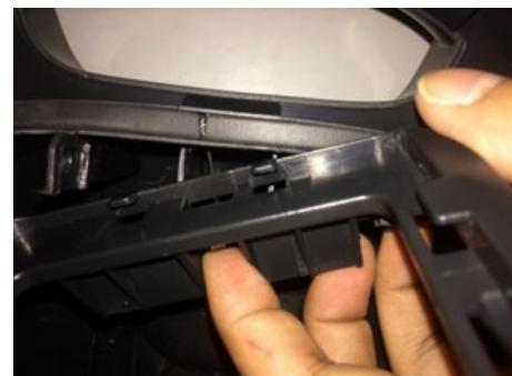
**03.** Ouvrez la couverture avant et appuyez sur la partie inférieure pour retirer la couverture avant.
