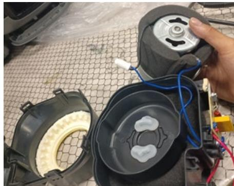
17. Retirez les 2 vis et retirez le potentiomètre.
