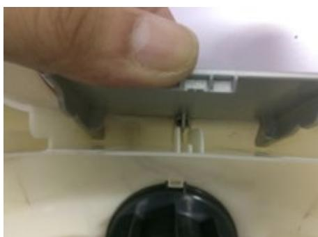
24. Utilisez un tournevis à tête plate pour retirer le bouton de déverrouillage de la grille de sortie d'air.
